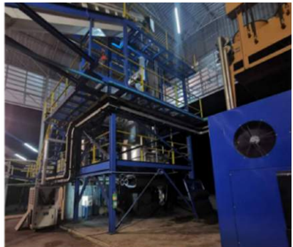
ระบบ 3-Stage Gasification
